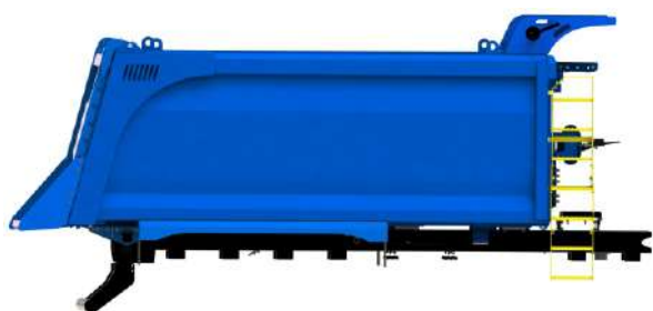
Кузов самосвальный прямоугольного сечения
